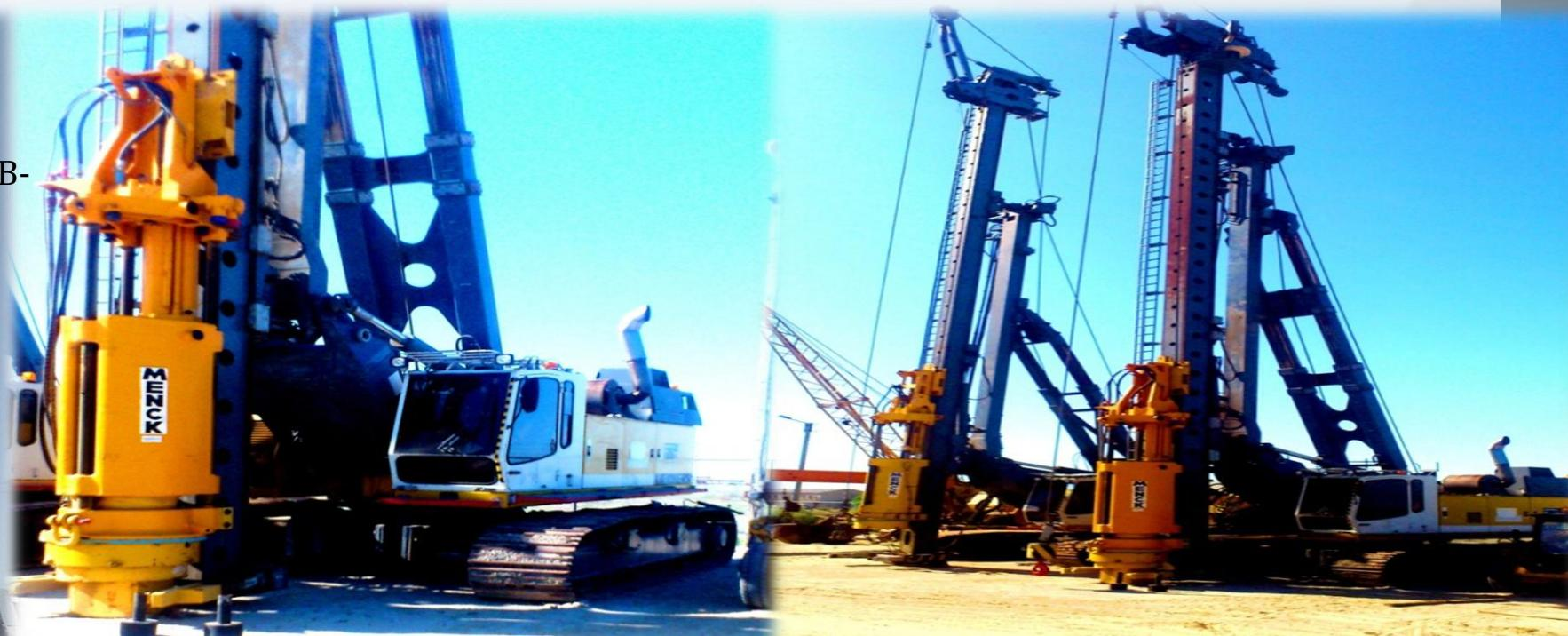
Гидравлический сваебойный агрегат LRB-150 на базе LIEBHERR HS843 HD/LRB-150
