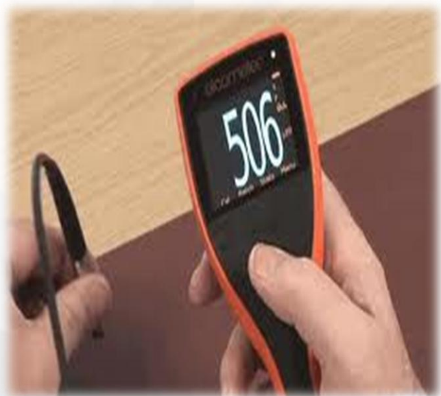
Elcometr 456 толщиномер покрытий
