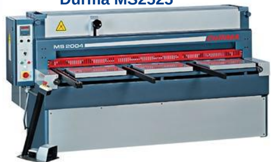
Электромеханическая гильотина Durma MS2525
