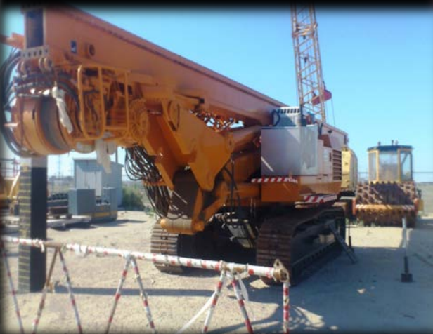
Сваебойная машина Юнттан для сваебойных работ, iPiler (PCD2) с офисной программой PMO, включая количество ударов/мин. и энергии удара.
