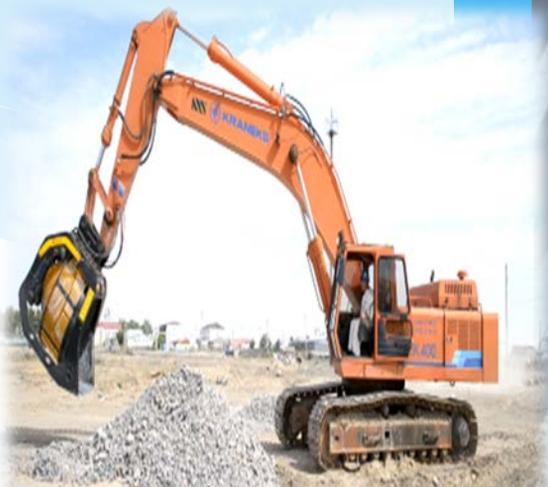
Экскаватор KRAANEKS ЕК-400, V=1.9m<sup>3</sup> 2011 г. с навесным оборудованием –просеивающем ковшом MB-С для сортировки природных материалов на стадиях до и после дробления
