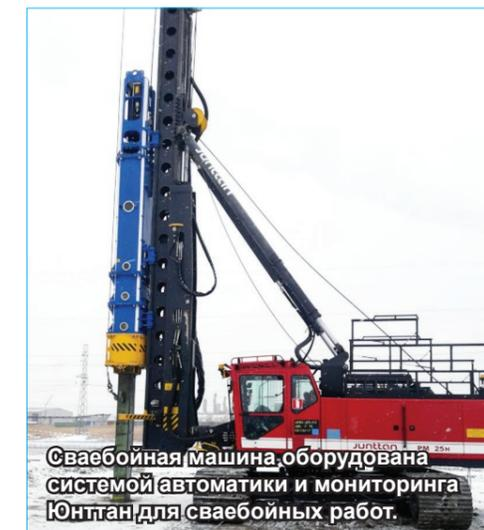
Сваебойная машина, оборудована системой автоматики и мониторинга Юнттан для сваебойных работ.
