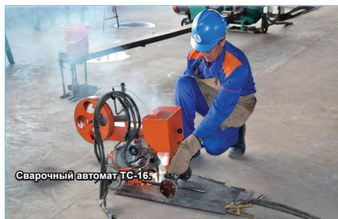
Сварочный автомат ТС-16.
