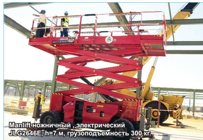
Manlift ножничный, электрический JLG2646E, h=7 м, грузоподъемность 300 кг.
