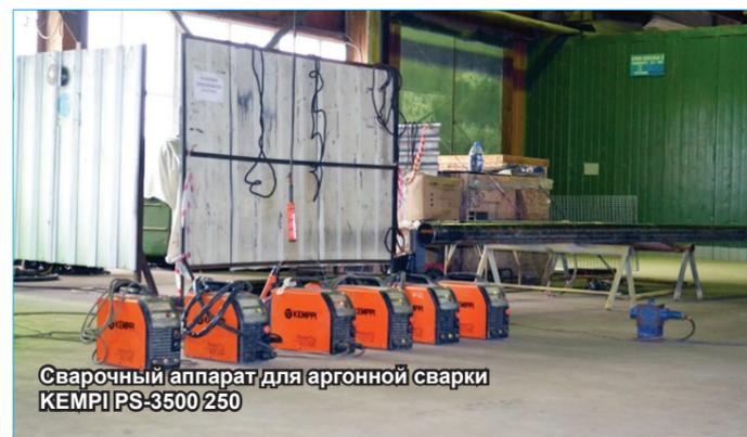
Сварочный аппарат для аргонной сварки KEMPI PS-3500 250
