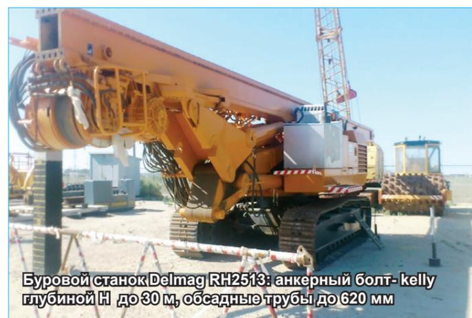
Буровой станок Delmag RH2513: анкерный болт-kelly глубиной H до 30 м, обсадные трубы до 620 мм
