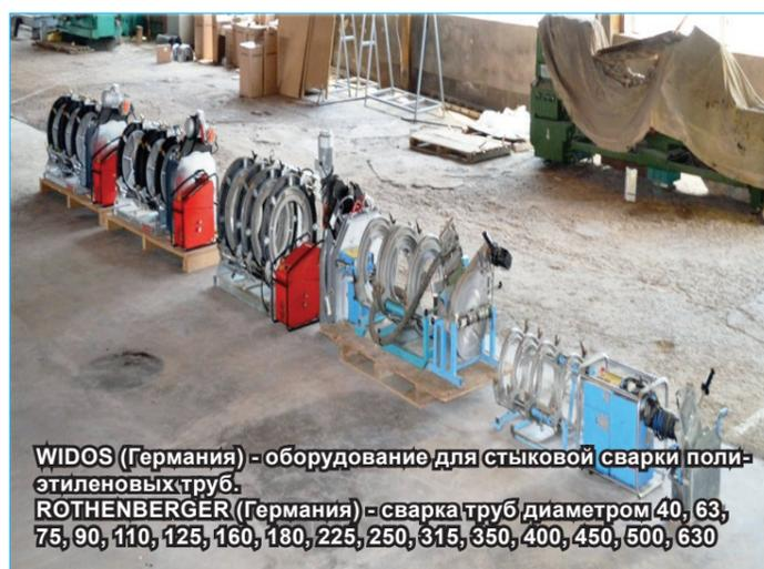
WIDOS (Германия) - оборудование для стыковой сварки полиэтиленовых труб.
