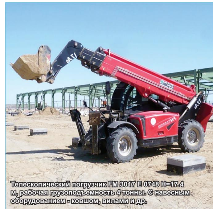
Телескопический погрузчик FM 3017 E 0743 H=17.4 м, рабочая грузоподъемность 4 тонны. С навесным оборудованием - ковшом, вилами и др.
