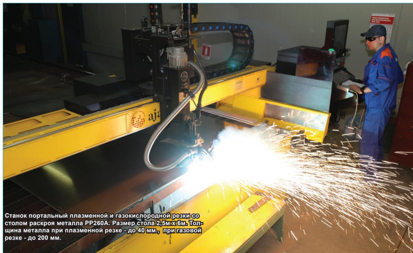
Станок порталный плазменной и газокислородной резки со столом раскроя металла PP260A. Размер стола 2,5мх6м. Толщина металла при плазменной резке - до 40 мм., при газовой резке - до 200 мм.
