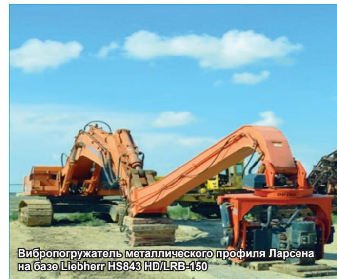
Вибропогрузатель металлического профиля Ларсена на базе Liebherr HS843 HD/LRB-150
