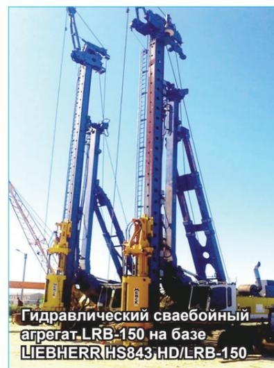
Гидравлический сваебойный агрегат LRB-150 на базе LIEBHERR HS843 HD/LRB-150
