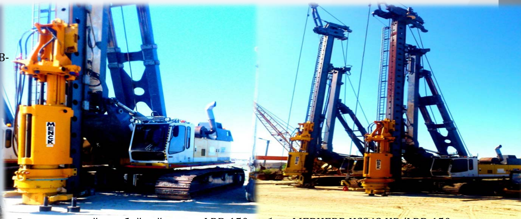
Гидравлический сваебойный агрегат LRB-150 на базе LIEBHERR HS843 HD/LRB-150
