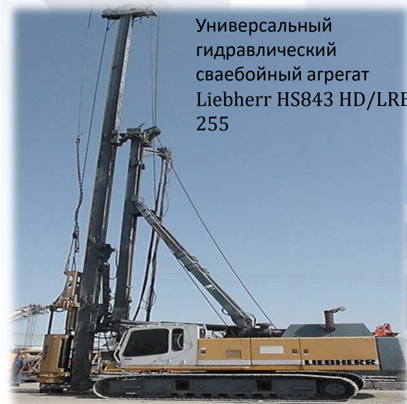
Гидравлический сваебойный агрегат LRB-150 на базе LIEBHERR HS843 HD/LRB-150
