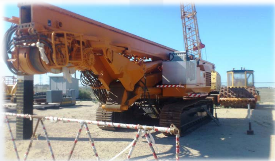
Буровой станок Delmag RH2513: анкерный болт- kelly глубиной Н до 30 м, обсадные трубы до 620 мм
