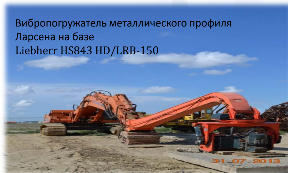
Гидравлический сваебойный агрегат LRB-150 на базе LIEBHERR HS843 HD/LRB-150
